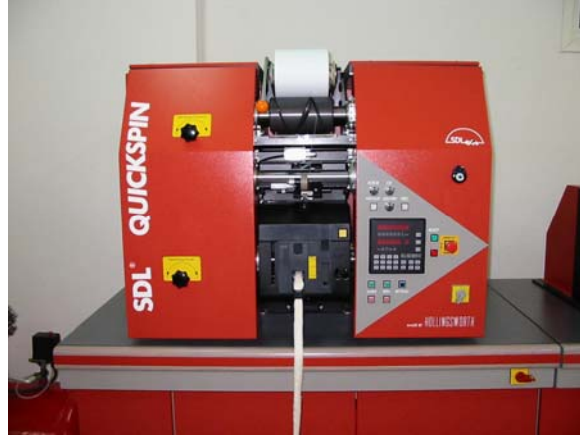
Şekil 3 : Laboratuvar tipi bir üniteli rotor iplik eğirme makinası (quickspin)
